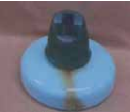
El óxido aparece en el capuchón debido a la corriente superficial
